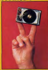
Voici le disque dur PCMCIA de Maxtor. Il contient 105 Mo ! Et ça marche ! Cette photo n'est pas truquée !
