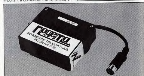
Étonnez vous amis. Non seulement l'interface Noguera pour Amstrad CPC émulé votre micro en Mintel, mais elle le transforme en centre serveur : elle lui permet de créer et de transmettre des pages-écrans.
