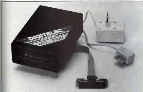
Le modem Digitelec possède d'origine l'interface RS 232 et ne coûte pas trop cher. Mais il faut des logiciels pour l'utiliser sur CPC. Vidéomatique en propose : Minteltec, Servitelec et Minteltec.
