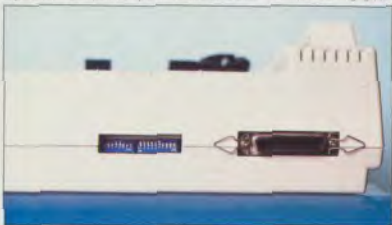
À gauche, les câbles dans leur logement. À droite, la sortie parallèle.
