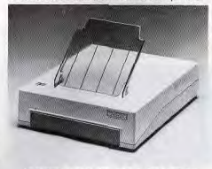
Le scanner à enroulement entraîne le papier comme une imprimante à friction.
