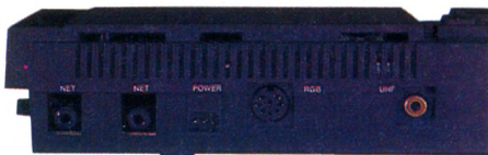
Visite guidée de la face arrière du QL : de gauche à droite, des sorties réseau, alimentation, péritel, antenne, RS 232 C, contrôle plus un connecteur de MEM.
