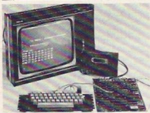
A partir d'un noyau relativement simple et bon marché constitué d'un affichage numérique, d'un clavier hexadécimal, d'un micro-processeur et d'un élément de mémoire RAM, on peut progresser au fur et à mesure des besoins et des disponibilités financières par adjonction de périphériques, de RAM supplémentaire, ou de mémoire ROM contenant des logiciels nouveaux (Basic plus étendu, interfaces divers, langages Fortran ou Pascal),
