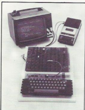
**Le système de base, se raccordant directement à un téléviseur standard et à un magnéto cassette, comprend le clavier alphanumérique, et la carte de base en kit, avec :**
