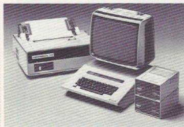
Le Micro-Ordinateur ITT 2020 (Apple System) peut être équipé de 16 à 48 K octets de mémoire vive (RAM). Il peut être complété par un ou plusieurs lecteurs de disquettes d'une capacité de 116 K octets formatés (mémoire utile : 104 K octets environ). On lui adjoint, par ailleurs, une imprimante ITT 779 à aiguille, 60 cps unidirectionnelle de 80 à 132 colonnes (entraînement par Picots). Cet ensemble est complété par un écran vidéo noir et blanc de 36 cm (de diagonale).
