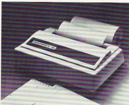
sions européennes, ce jeu est modifié pour permettre les variantes nationales telles que les accents. La vitesse d'impression peut aller jusqu'à 100 caractères/seconde. Le papier utilisé peut être sous forme de feuilles volantes en rouleau ou à entraînement par picots. Un microprocesseur, qui gère l'ensemble de l'im-
