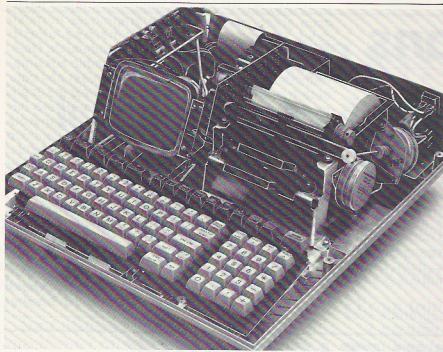
Clavier en place, mais sans carrosserie : les deux moteurs de l'imprimante sont nettement visibles, le clavier est fixé au-dessus de la plaque d'unité centrale.
