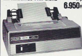
Imprimante par ligne à entraînement par friction. Peut imprimer jusqu'à 21 lignes de 132 caractères par minute sur du papier en rouleau pouvant avoir jusqu'à 25 cm de large.
