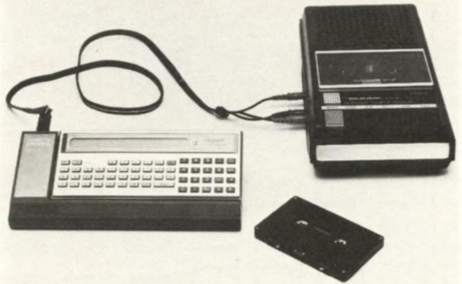
Le système est relié à l'interface à cassettes par le connecteur que l'on voit sur la gauche de celle-ci. Un schéma collé à l'interface rappelle comment se fait le branchement. Une fois celui-ci effectué, il ne reste plus qu'à brancher l'interface à un magnétophone.
