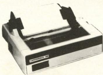
C'est l'imprimante classique, peut-être la plus vendue. Sa principale caractéristique est peut-être sa robustesse. D'un poids aussi imposant que ses dimensions, son moteur synchrone ventilé lui permet de fonctionner en continu pendant des heures sans dommage. Elle ne possède pas de caractères minuscules, ce qui n'est pas un inconvénient dans la majorité des applications de gestion.
