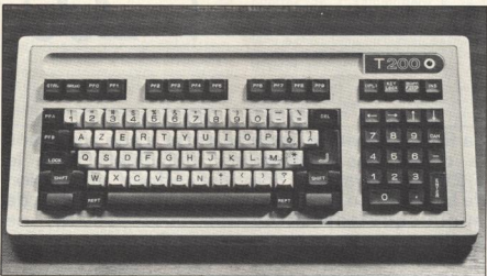
3. Un clavier Azerty très complet, avec bloc numérique, touches de fonction et de déplacement de curseur.
