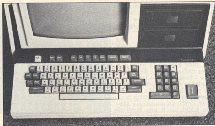
2. Un clavier complet permet de créer directement les ordres Basic avec la touche ESC.
