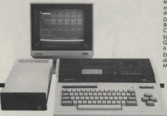
Microprocesseur 8 bits, rapide, sous CP/M - une ou deux unités de disquettes et 64 K octets de mémoire : les vraies dimensions d'un "pro".
