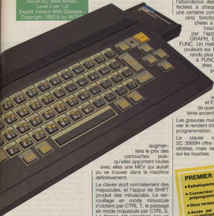
Nous avons alors un « 12284 bytes free » suivi d'un « Ready ». Il existe deux versions de Basic, ce qui impose quelques explications. La machine ne possède à l'origine que 16 Ko de mémoire vive réservés à l'affichage, rien pour les programmes. Étrange-
