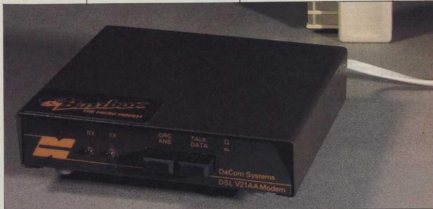
Quand le modem est « OFF LINE », il n'est pas sur « ARRET » : il surveille l'arrivée d'un éventuel appel, prêt à envoyer une stridente porteuse dans... les oreilles de l'humain téméraire, ignorant qu'un modem sournois le guette à l'autre bout de la ligne !
