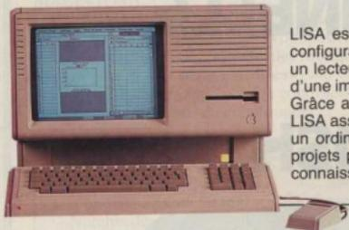
LISA est un ordinateur personnel très puissant et facile à utiliser. Dans sa configuration promotionnelle, il est équipé de 1 M d'octets de mémoire centrale, un lecteur de micro-disquettes de 400 K, un disque dur PROFILE de 5 M et d'une imprimante IMAGEWRITER.
