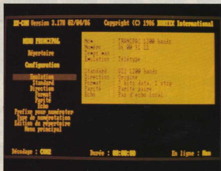
Configuration / modification d'un numéro de répertoire.
