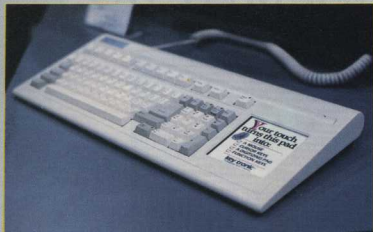
UNE NOUVELLE RACE DE CLAVIER pour les PC millésime 1987 ? Keytronic, spécialiste de l'Art, dote le clavier AT d'une zone sensible réservée aux fonctions spécialisées (jusqu'à 36). Pour les adversaires de la souris.
