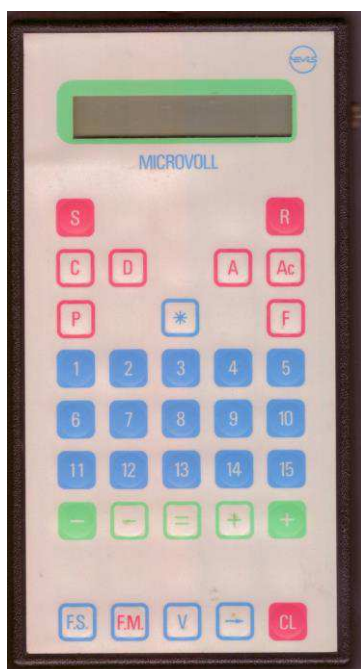
Figure 26 : MICROVOLL, machines dédiée à l'observation et l'analyse des matches de Volley-ball (NEVES électronique, Paris) février 1988
