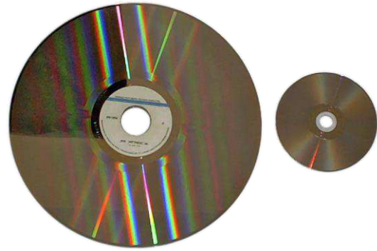
Figure 88 : LaserDisc Comparaison des dimensions d'un LD 30 cm et d'un DVD 12 cm.
