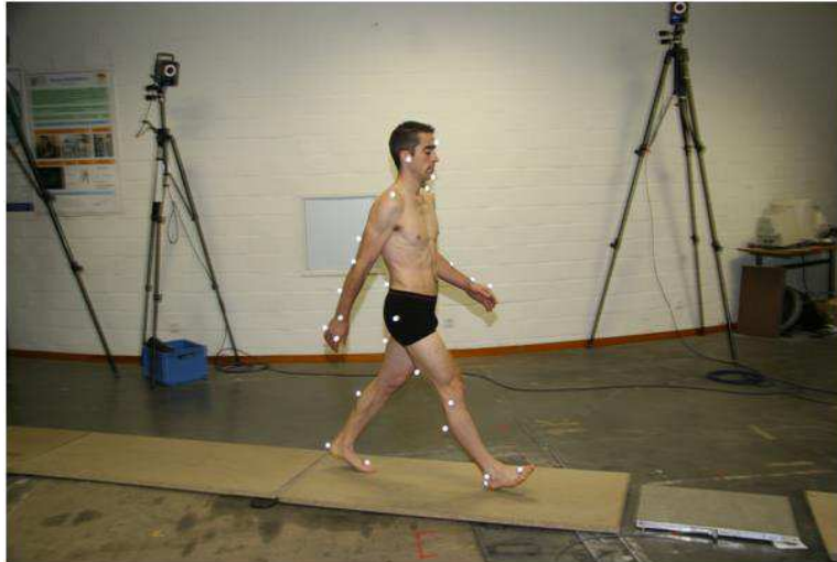
Figure 76 : Illustration d'une expérimentation de capture du mouvement de marche : les flashes équipant chaque caméra émettent une lumière infrarouge qui est réfléchié par les marqueurs corporels.
