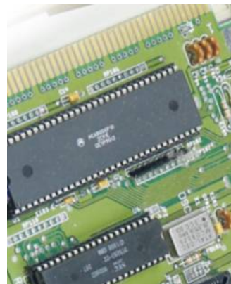
Le Motorola 68000, star des 16 bits (dans un Amiga 500).
