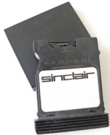
Un Microdrive, une bande magnétique sans fin utilisée sur le Spectrum.
