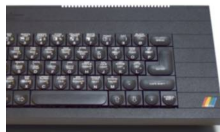
Le ZX Spectrum+ est doté d'un clavier avec des touches classiques. (Wikipédia)
