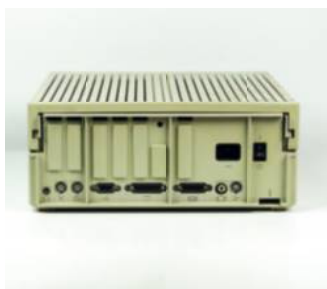
L'Apple IIGS inaugure le bus ADB (Apple Desktop Bus), réutilisé dans les Macintosh.
