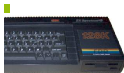
Le ZX Spectrum +3, fabriqué par Amstrad, possède un lecteur de disquettes intégré. (Wikipédia)
