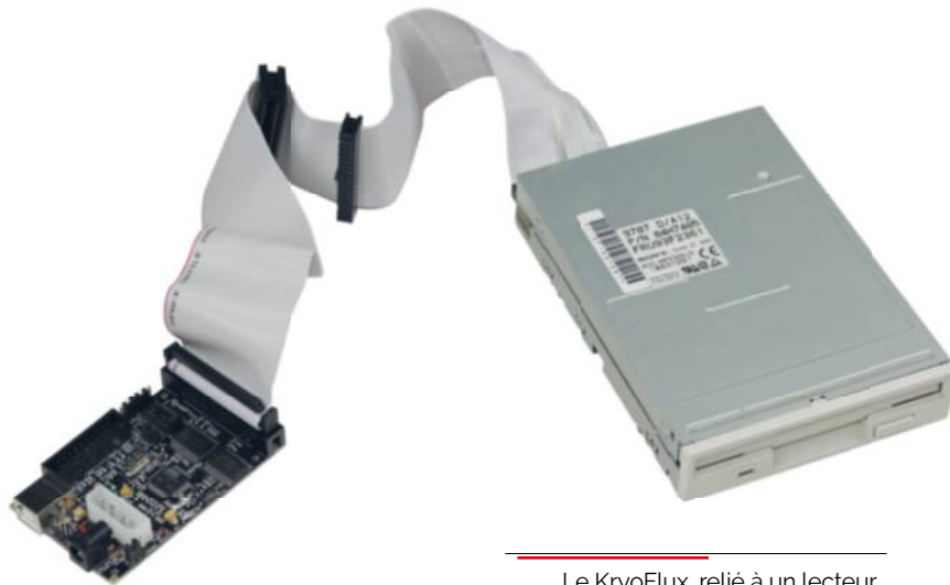
Le KryoFlux, relié à un lecteur de disquettes 3,5 pouces de PC.
