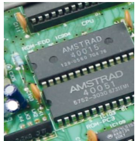
Ces deux puces de mémoire ROM contiennent le BASIC de l'Amstrad CPC464.
