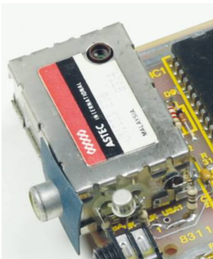
Le modulateur RF (radiofréquence) d'un ZX81, la pire solution en 2016.
