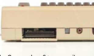
Le Commodore 64 proposait un connecteur d'extension à l'arrière.
