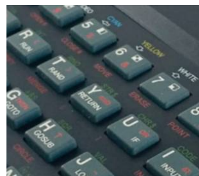
Avant de passer au mécanique, les constructeurs intégraient des touches en gomme, façon calculatrice.
