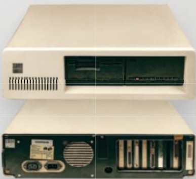
Les premiers PC utilisaient essentiellement des cartes d'extension pour la connectique.
