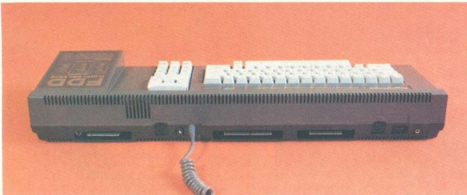
Anschlüsse (v.l.n.r.): Floppy/Monitor/5V/12V/Expansion Port/Drucker/DIN-Anschluß für Recorder/Joystick/Stereo
