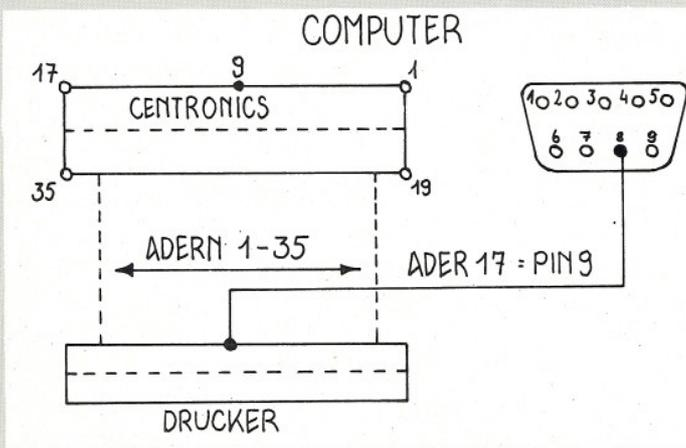
Centronics-Stecker am Computer abziehen und mit Schraubenzieher öffnen. Achtung! Der Steckerdeckel könnte klemmen. Flachkabel abziehen. Dabei aber nicht die Kontakte mit herausziehen (notfalls vorsichtig zurückdrücken). Stecker mit Hilfe des Schraubstocks (bzw. oben erwähnten Schraubzwingen) ca. 20 cm tiefer neu montieren. Der Deckel ist nur so weit reinzudrücken, daß die Kontakte eben die Isolierung durchstoßen.
