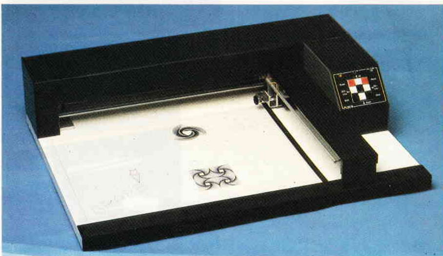
Bild 2: ... entsteht ein DIN A 3-Plotter im Selbstbau
