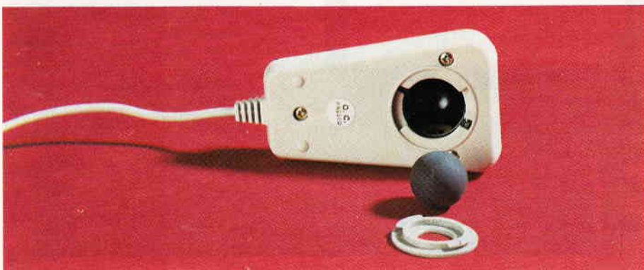
Bild 8: Ruhige Kugel – die Mausmechanik
