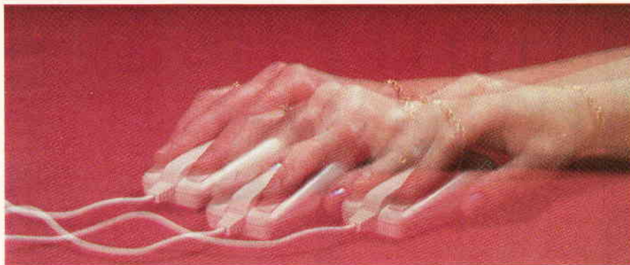
Bild 7: Der Trennsteg der Maus wirkt störend
