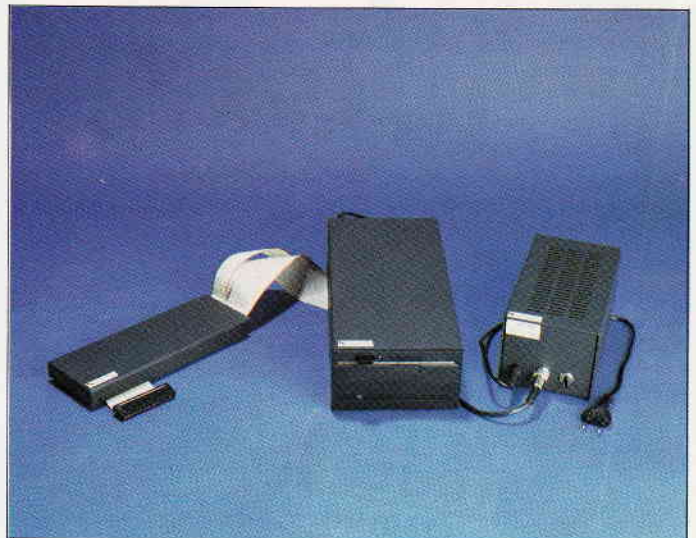
Das WD20 Hard-Disk-Subsystem von vortex. 20 Megabyte Daten auf einer Platte — ein wahrer „Speicherriese“. S. 136
