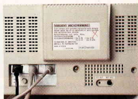
Bild 12: Alle Wege führen zum Monitor – er beherbergt die gesamte Stromversorgung
