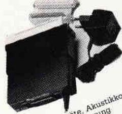
RS 232-Schnittstelle für den Anschluß peripherer Geräte in serieller Schnittstelle wie Schreibmaschine. Komplett mit 6128 178,-
