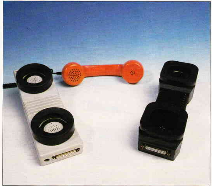
Bild 6: Mund und Ohr des CPC: der Akustikkoppler...
