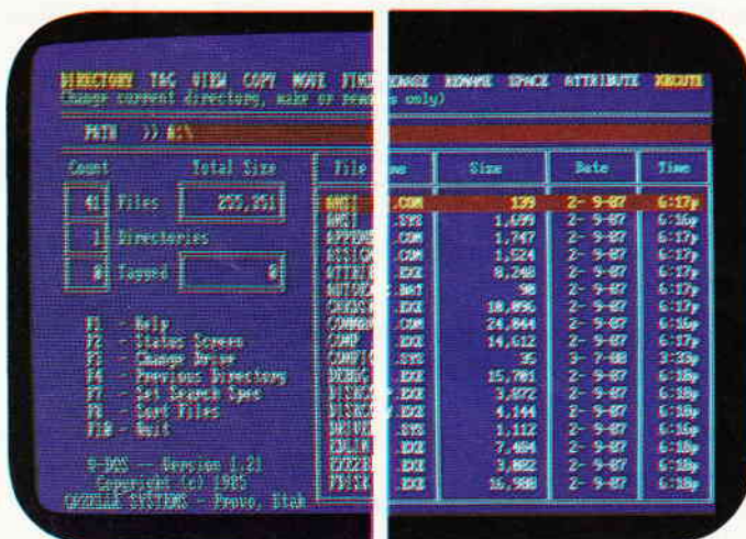
Bild 2: Der Unterschied ist beachtlich: links 'normale' CGA-Auflösung, rechts das gleiche in EGA-Qualität...
