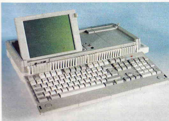
Abb. 2 : Der PPC 512 - Ein portabler MS-DOS-Rechner mit 3,5"-Floppy.
