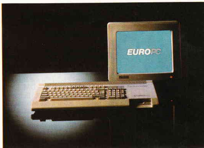
Abb.5 : Der Schneider Euro-PC hat ein in die Tastatur eingebautes 3,5" Floppy-Laufwerk.
