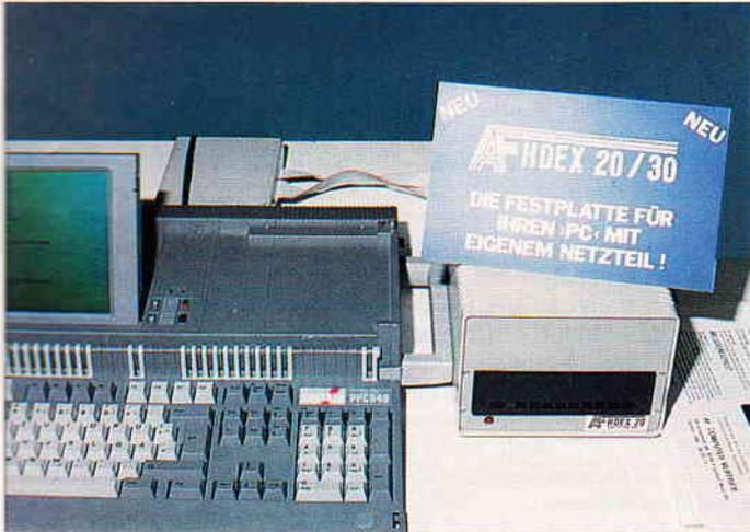
Festplatten für Personal Computer stellt die Frankfurter Firma AF Computer Vertrieb her. Die Festplatten mit den Bezeichnungen AF HDEX 20 (20 MByte), AF HDEX 30 (30 MByte) und AF HDEX 40 (40 MByte) sind über einen externen Controller auch an die PPC 512/640-Rechner von AMSTRAD anschließbar. Die Preise für die Festplatten liegen dabei von ca.
