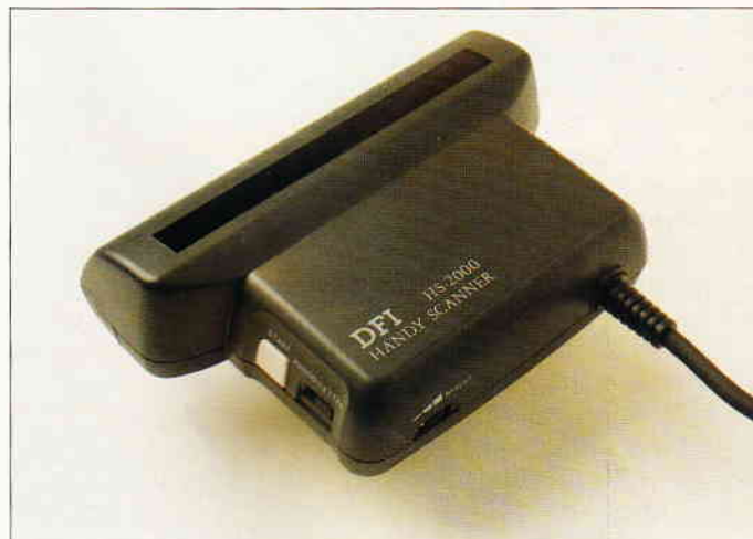
Abb. 6: Ein Scanner tastet ein Bild ab, setzt die Farbwerte in Graustufen um und gibt die wiederum in Digitalimpulse umgewandelten Stufen an den Rechner weiter, der sie als Screen aufbaut.
