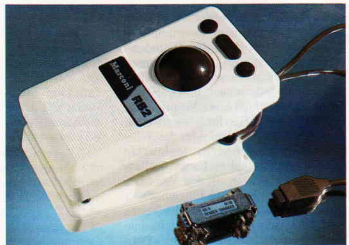
Abb. 4: Den umgekehrten Weg geht der Trackball. Man nehme eine Maus und stelle sie auf den Kopf....
