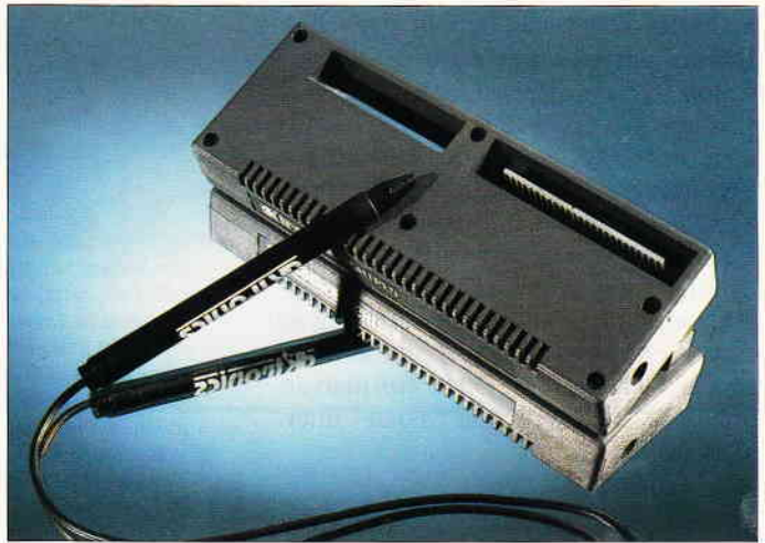
Abb. 5: Einen völlig anderen Weg geht der Light-Pen, der Lichtschreiber, hier wird die aktuelle Bildschirmzeile abgefragt.
