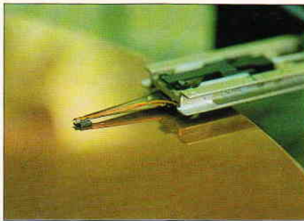
Bild 1: Berührungsängste: zwischen Schreib-/Lesekopf und Magnetschicht sind gerade 1/1000 mm Luft...
