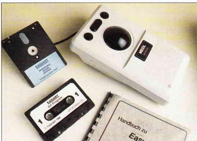
Bild 1: Die Marconi RB2-Trackball-Ausrüstung besteht aus: Trackball, 1 Kassetten- und 1 Disketten-Version von Easyart und einem deutschen Handbuch.
