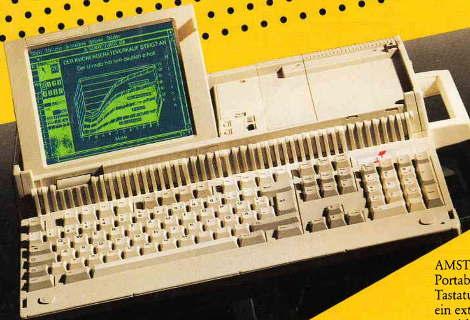
Völlig netzunabhängiger Portable PC mit AT-Tastatur: AMSTRAD PPC 512. Mit 512 KB RAM, zwei 3 1/2"-Laufwerken mit 720 KB, Super-Twist LCD-Display, MS-DOS 3.3, Netzteil, Tragetasche.
