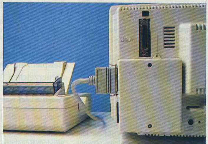
Abb. 2: Auch die PCW-Rechner können neben ihrem eigenen Drucker einen Fremd-Drucker mit Centronics-Anschluß betreiben, wenn sie selbst über die Centronics-Schnittstelle verfügen.
