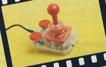
Competition Pro Extra Transparentes Gehäuse, Microschalter, einstellbare Dauerfeuer und Slow-Motion-Option.
