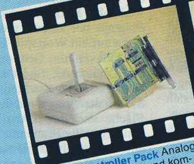
Speed King Konix recht geformter Analog-Joystick für IBM PC und kompatible Computer, mit Controller Card.
