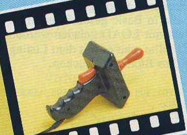
Phasor One Ein Joystick mit Pistolengriff, Microschaltern und extra langem Anschlußkabel!
