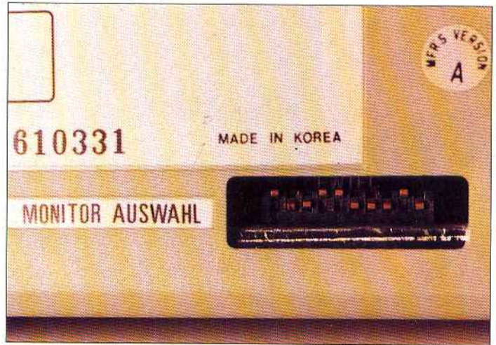
Abb. 2: Die DIP-Schalter des PC 1640 sind beim Einsatz der VGA-Grafikkarte wie im Bild abgebildet einzustellen.
