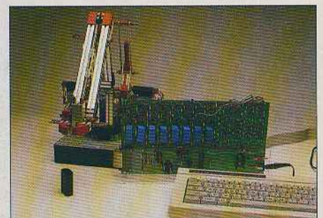
Für den PCW haben wir ein Schaltinterface getestet, mit dem externe Hardware angesteuert werden kann
