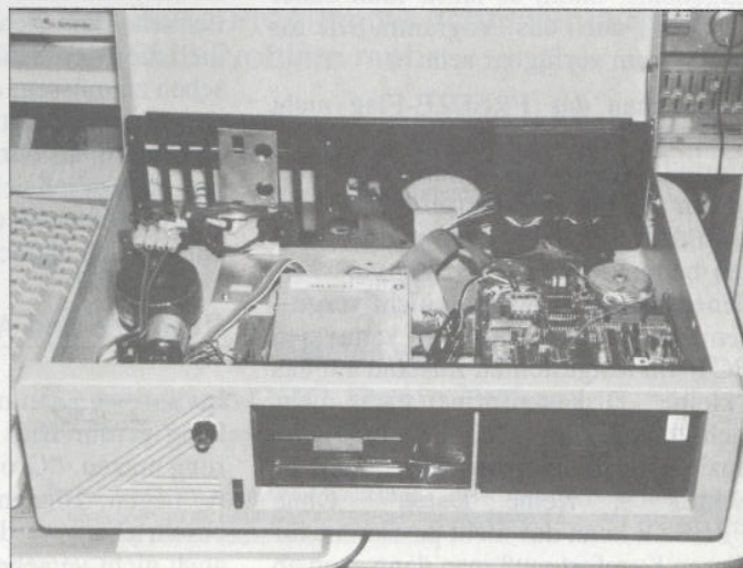
Bild 3: Die Floppy-Erweiterung, hier im Ausbau als selbständige Einheit
