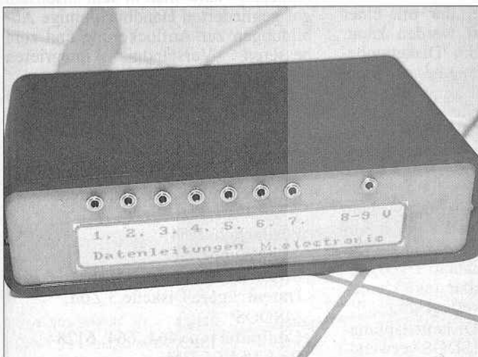
Das Schalt-Interface ist mit 7 Bit parallel geschaltet.
