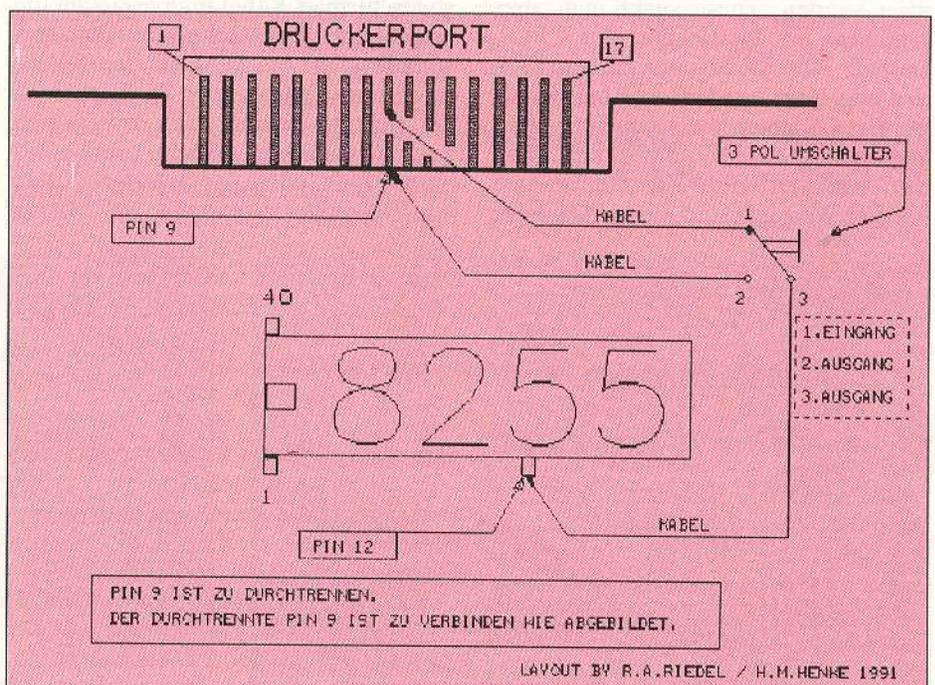
Bild 1: Schaltplan für 8-Bit-Umschaltung
