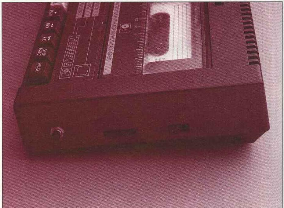
Bild 2: Eingebauter RESET-Taster
