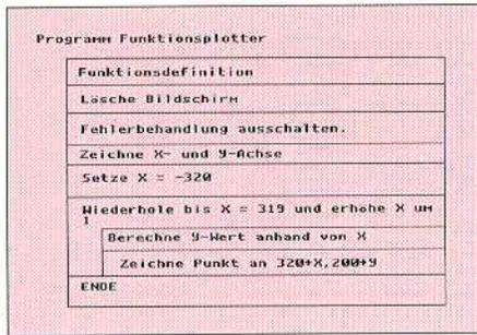
Die Darstellung des Programms – Funktionsplotter als Struktogramm
