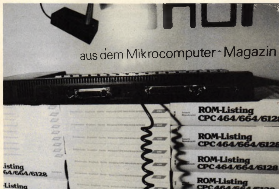
Unser Bild zeigt die Schnittstellen des CPC 6128.
