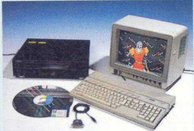
LUST AUF LDG: Player, Monitor, Computer (hier ATARI ST), Steuerungssoftware auf 3,5" Diskette, Interface, LDG-Disc
