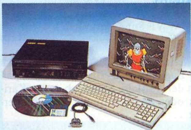
LUST AUF LDG: Player, Monitor, Computer (hier ATARI ST), Steuersoftware auf 3,5" Diskette, Interface, LDG-Disc
