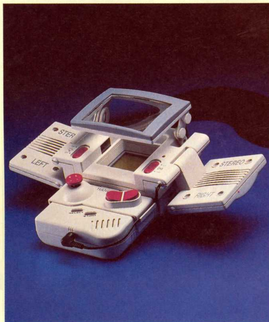
▲ Wer sagt denn, daß Tuning nur etwas für flotte Autos sei? Dank dieses Aufsatzes verfügt der Game-Boy über Lupe, Licht und Stereo-Lautsprecher-System.
