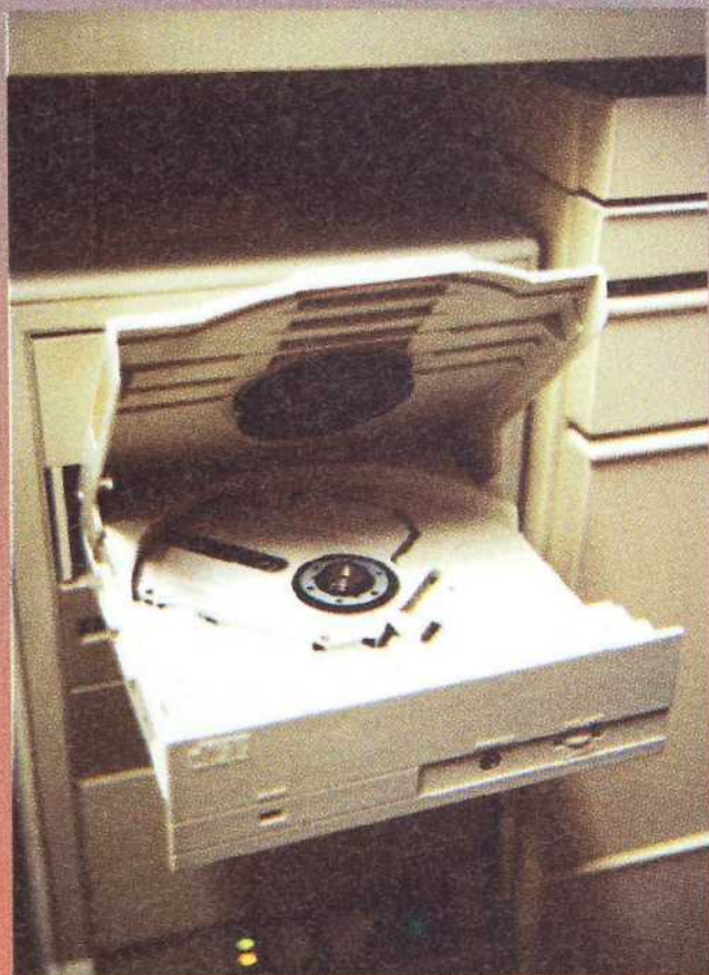
▲ Das weitverbreitete Mitsumi-Laufwerk mit AT-Bus-Interface für PCs: Die neueren Serien sind sogar "multi session"-fähig, wenn auch extrem langsam. Dieses Laufwerk braucht anders als viele andere keinen "Caddy" (Einführ-Kassette), sondern frißt die CDs "roh"
