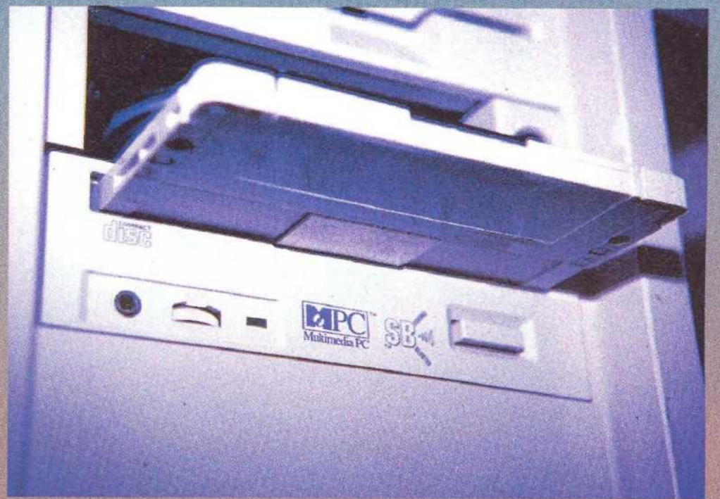
▲ Das Panasonic-Einbaulaufwerk für PC (baugleich auch als "Soundblaster"-Laufwerk verkauft). Hier schaut der "Caddy" heraus. In eine solche Hilfskassette muß man jede CD zuerst einwecken, bevor sie ins Laufwerk kann
