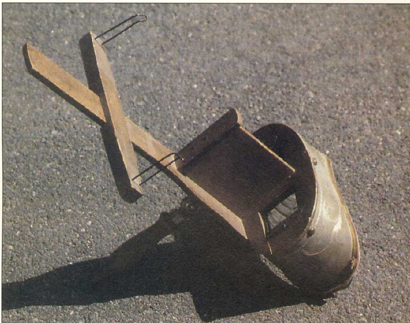
Das historische Betrachtungsgerät für Stereo-Papierfotos des Formats 9x9 ist sehr simpel aufgebaut: zwei Linsen, eine verstellbare Bühne für den richtigen Abstand der Vorlage – fertig!
