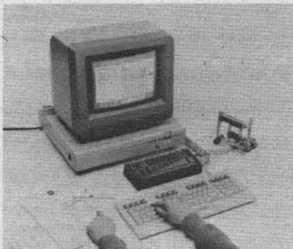
LEGO Technik Control ist der Einstieg der bekannten Firma in die Computerwelt. Mit dem System, das für Schulen vorgesehen ist, soll in Steuerungsaufgaben eingeführt werden.
