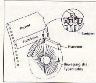
So funktioniert ein Typendruck
