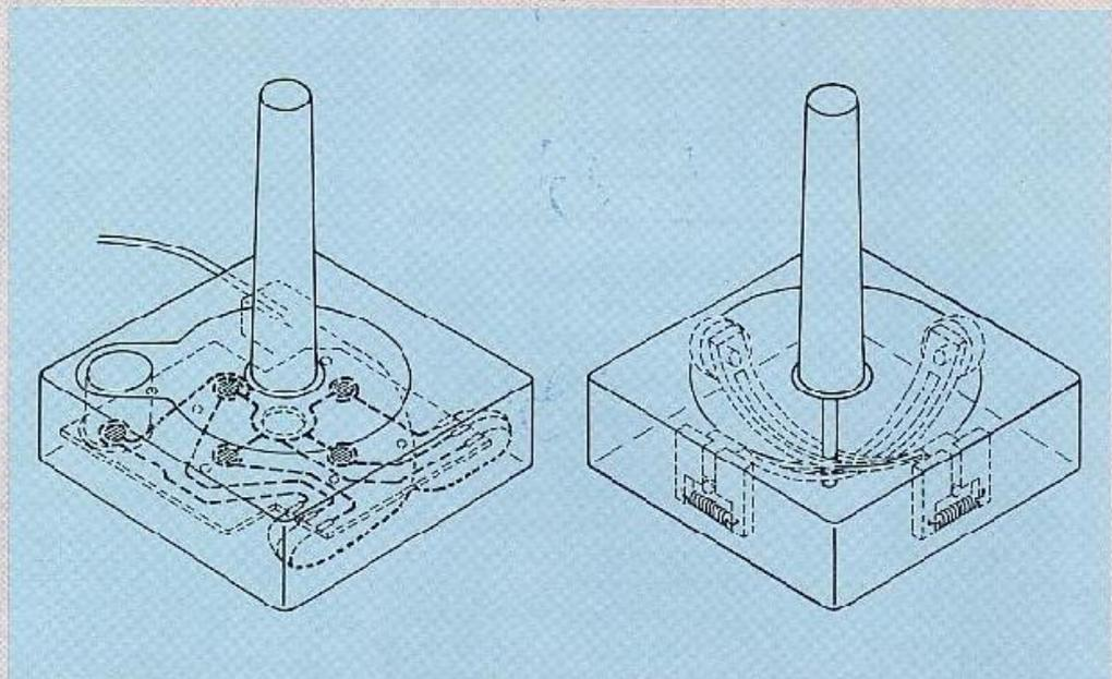
Joystick von Atari mit den Schaltern
