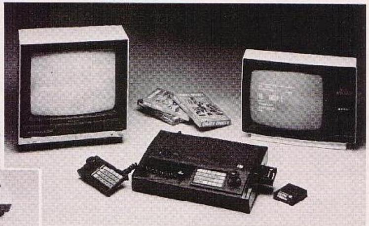
**LASER 110/210** Mikroprozessor Z80A, 16 KByte ROM, 4 KByte RAM (LASER 210: 3 KByte RAM und 8 Farben), Tongenerator. Erweiterung: 16 KByte RAM bzw. 64 KByte RAM, Drucker, Interface-Modul. Zahlreiche Programme erhältlich sowie in Vorbereitung (z. E. Assembler)!
