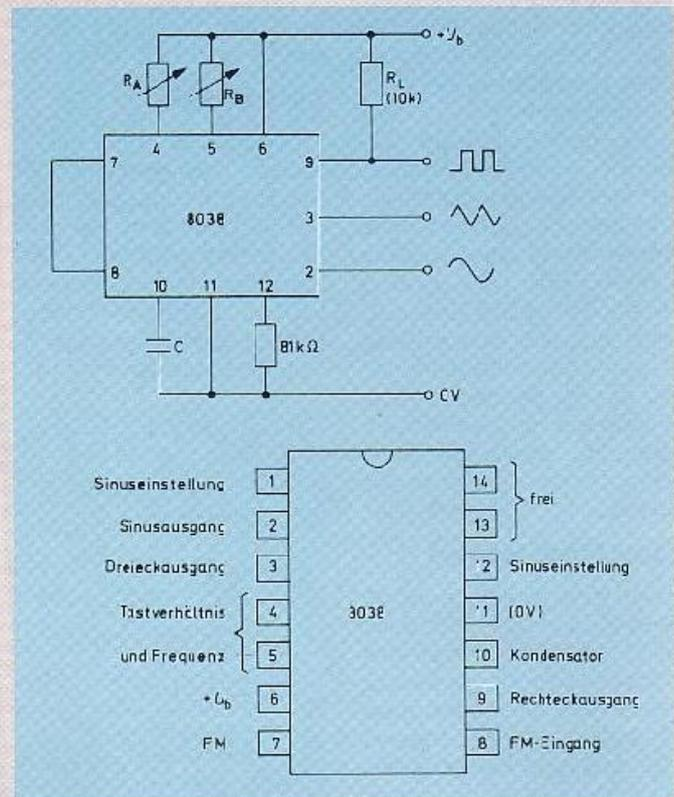
Anschlußschema und Grundschiung des ICL 8038
