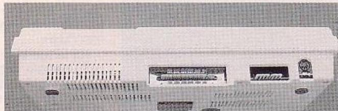
Anschlüsse für Expansionsbox, Recorder und Monitor
