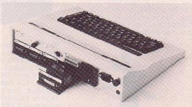
technischen Abläufen. Das Grundgerät enthält 16 KByte Speicher, ein Kassetten-Interface, Echtzeituhr und Wecker. Zusätzlich lieferbare Module sind digitale und analoge Ein-/Ausgabe sowie Leereinschübe zur individuellen Bestückung. Als Programmiersprache wurde
