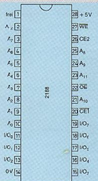
Anschlußschema des RAM-Typ 2188 mit 8192 x 8
