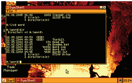
Directory-Ansicht in der Shell: Der Filemanager verwaltet neben AMSDOS auch alle FAT-Formate bis 128GB.
