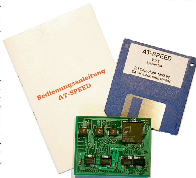
Die AT-Speed Karte verwendet einen 80286 Prozessor von AMD.
