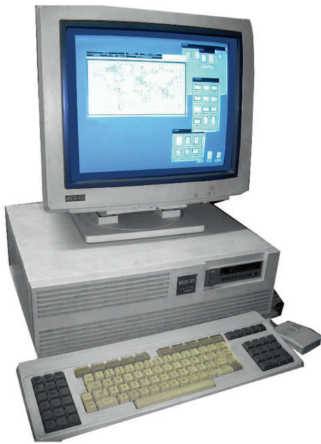
Die Apollo Domain DN4000 setzt auf einen Motorola 68030 Prozessor
