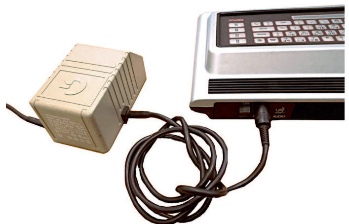
Das Netzteil eines Commodore 64 passt auch an die Max Machine.
