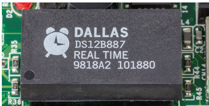
Enthält eine Batterie – der Uhrenchip vieler Workstations
