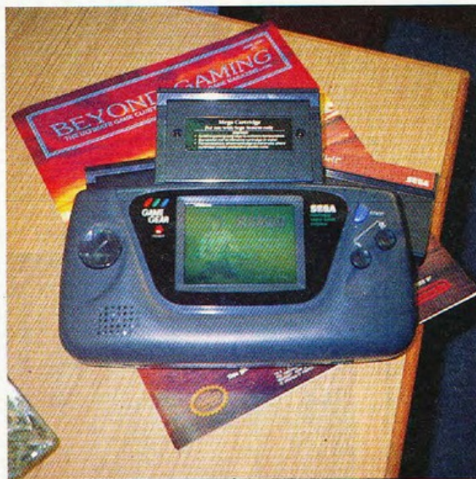
Praktisch: Mit diesem Adapter wird das Game Gear zum tragbaren Master System
