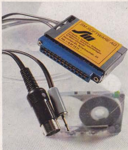
Mit diesem Interface mag der Commodore (via Userport!) auch andere Cassettenrecorder als die Datasette leiden.
